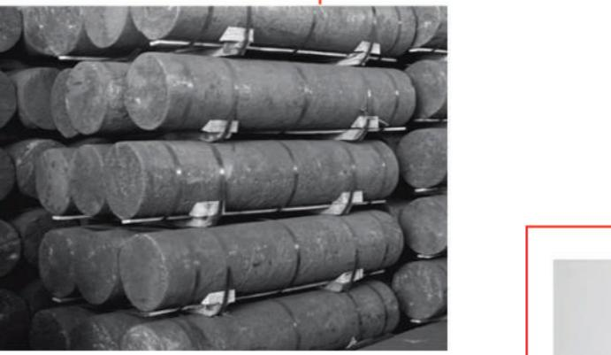
الکترود و نیپل ماشین کاری شده
